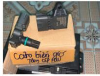
Cảm biến áp lực và nhiệt độ tăng áp Howo
