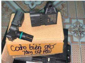
Cảm biến áp lực và nhiệt độ tăng áp Howo
