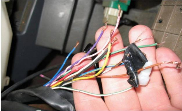
Rủi ro gây cháy của hệ thống điện không chỉ giới hạn trong khu vực khoang máy. Dây điện và các đầu nối được bố trí khắp thân xe. Chỉ cần một vị trí dây điện bị hở mạch cũng có thể dẫn đến rủi ro.
